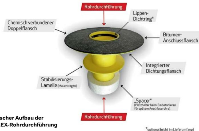
Bauwerkstrennelement diboFLEX T100: Es handelt sich dabei um eine intelligente Rohrdurchführung. Die ausgeklügelte Kombination einer Rohrmuffe mit einem fest integrierten Bitumenring ermöglicht es, die Bitumenbahnen anschließend direkt mit der Rohrdurchführung zu verbinden. Dadurch wird sozusagen eine Einteiligkeit aller Dichtebene bzw. der „Schwarzen Wanne“ erzielt: Die Rohrmuffe ist – wie beschrieben – mit dem Bitumenring fest verbunden und dieser wird in der Folge vom Bauwerksabdichter
