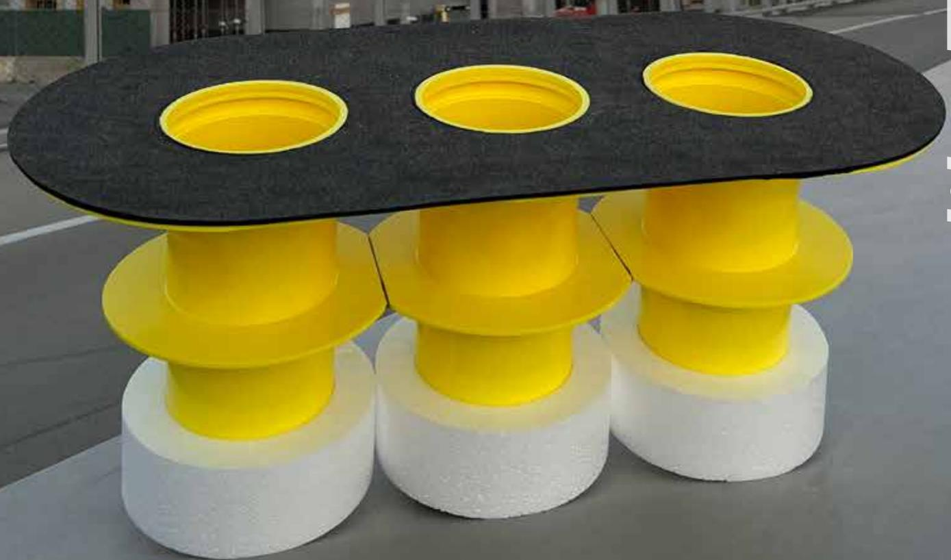
Basis ist die patentierte Rohrdurchführung der **T-Serie** von **diboFLEX**. Diese ist **einbetonierbar** und weist einen **einteiligen Flansch** mit **verbundenem Bitumenring** auf. Dieser Bitumenring kann **direkt mit den Bitumenbahnen verschweißt** werden. Dies ergibt eine einteilige, fugenlose und besonders dichte Bitumenhülle für das Bauwerk.
